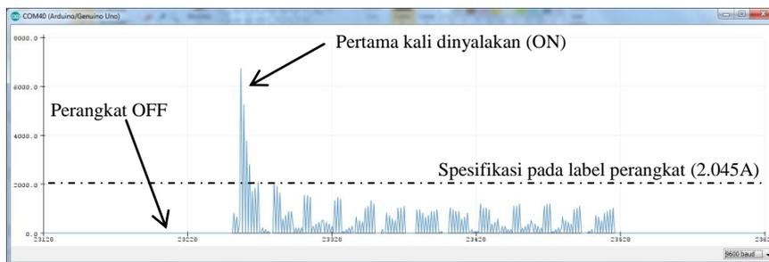
Gambar 5. Grafik konsumsi arus listrik untuk perangkat bor listrik.
